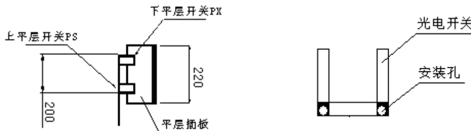
图 9.8 平层开关安装标准
