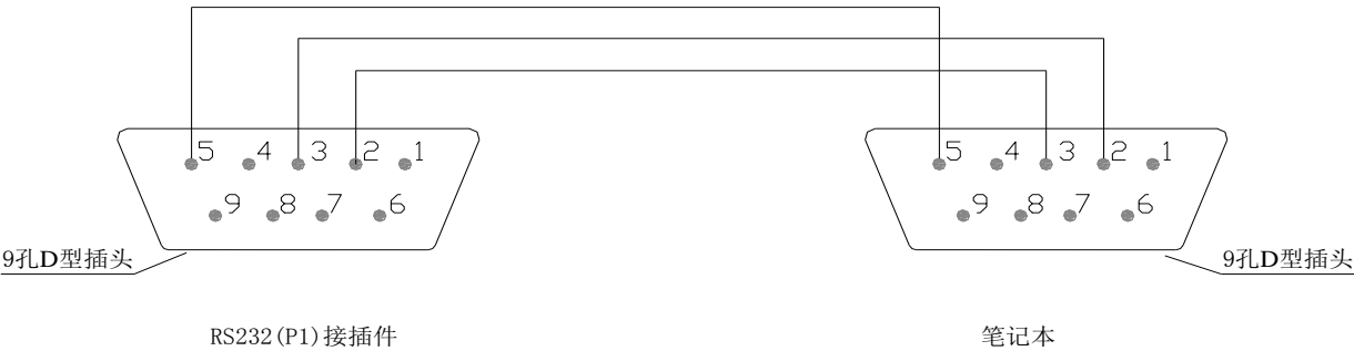
图 5.13 RS232 监控端口连接电脑示意图
