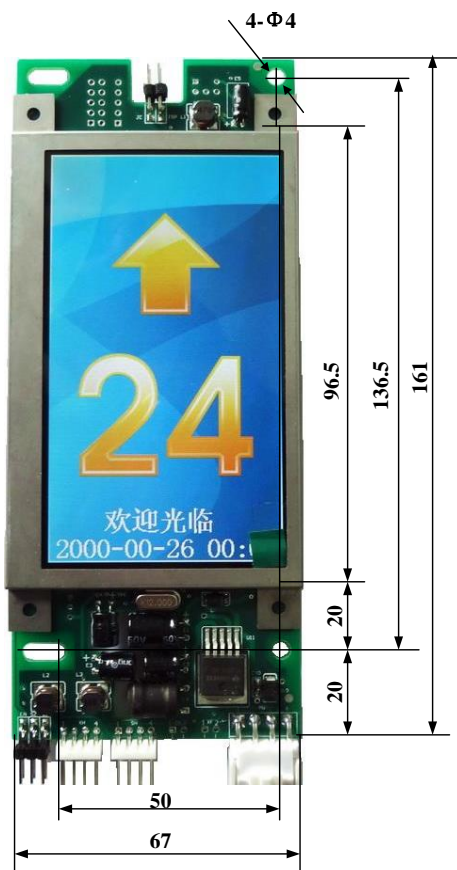
图 11.18 BL2000-HEH-L2.3 外形及平面安装尺寸
