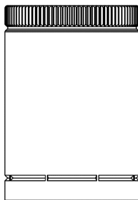
图 9 滚压防盗盖示意图
